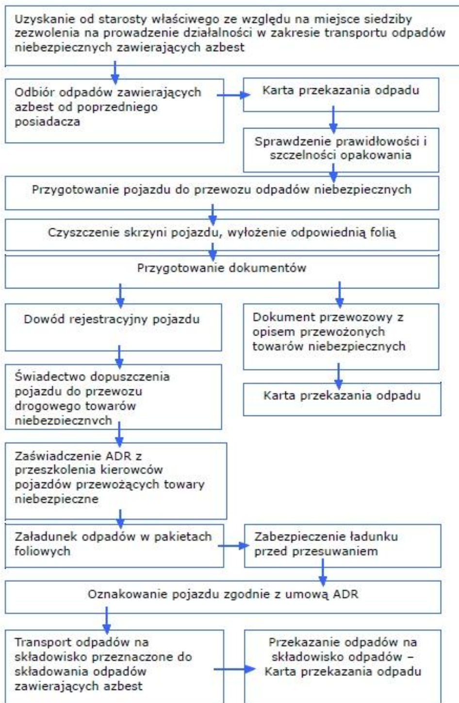
Rysunek 8. Schemat procedury dotyczącej przygotowania i transportu odpadów niebezpiecznych zawierających azbest.
